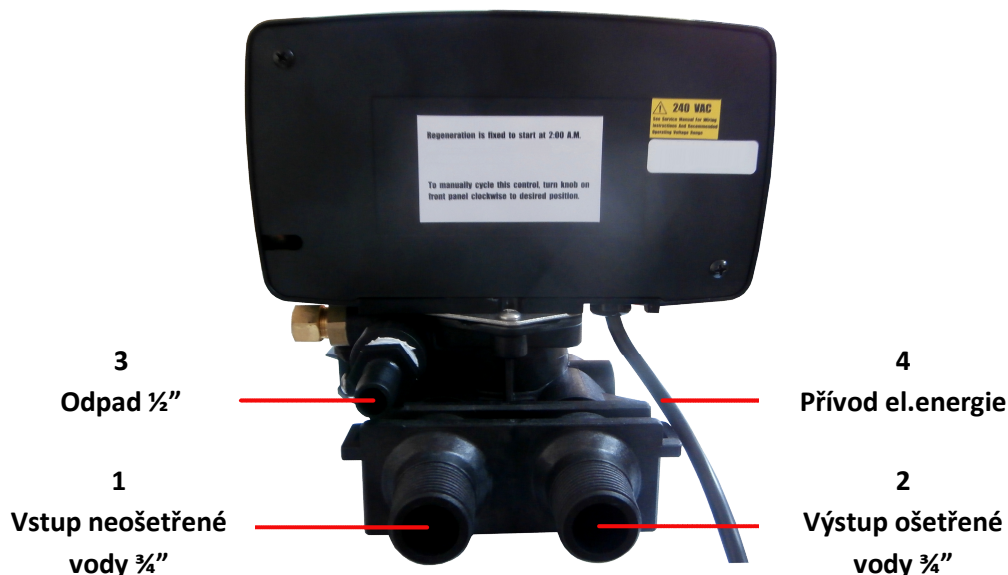
Obr. 2. Spojení na řídicí hlavici
