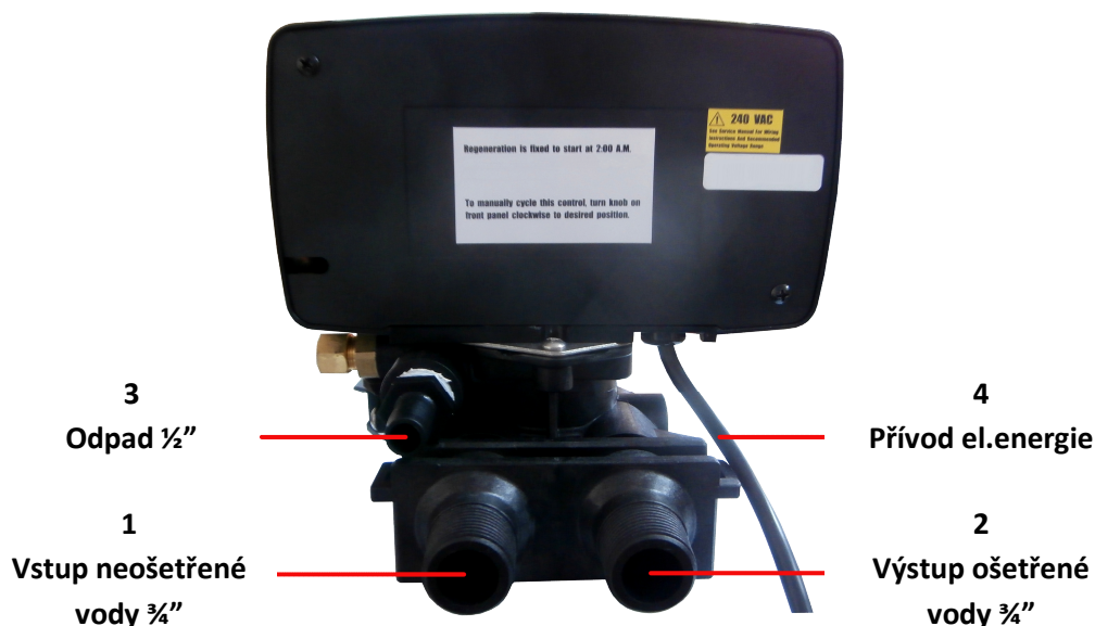
Obr. 2. Spojení na řídicí hlavici
